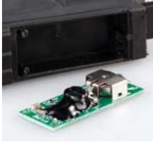
Chip mit Batterie. Fremdpatronen für Epson mit eigener Stromversorgung.
